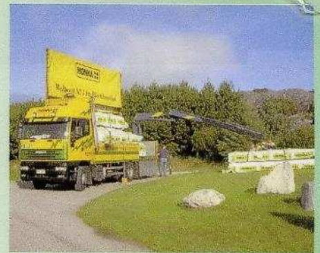
Der Mobilkran konnte nur für das Abladen und Sortieren der Pakete eingesetzt werden.
